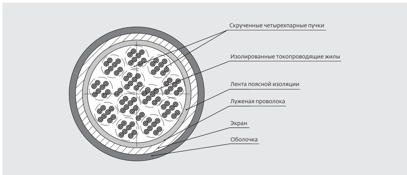
Формирование сердечника кабеля F/UTP емкостью  $50 \times 2 \times 0,52$  из 12 четырехпарных элементарных пучков и двух пар
