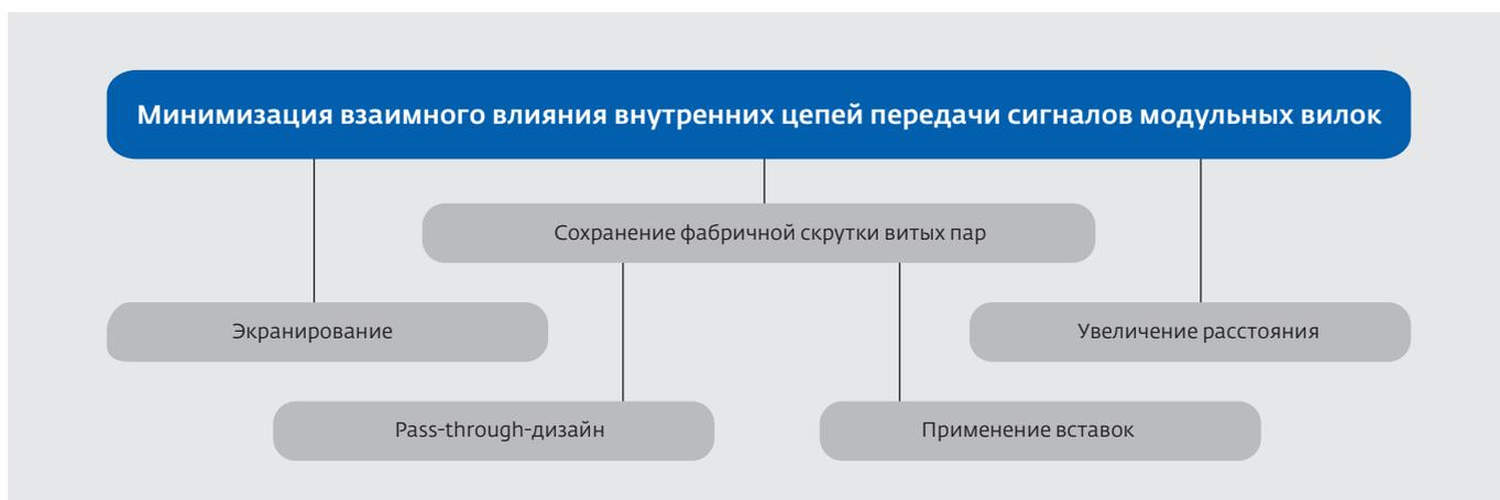
Рис.4. Направления подавления электромагнитной связи отдельных цепей передачи внутри корпуса вилки
