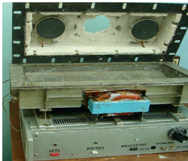
Рис.2. Используемая в экспериментах модель миксера с футеровкой
