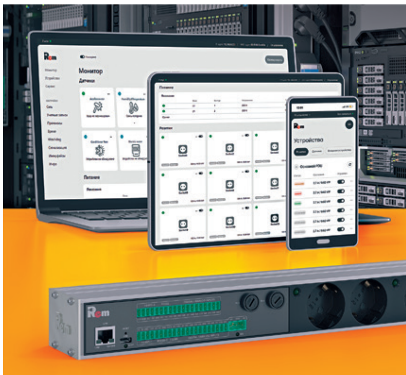
Рис.1. PDU REM-2MC – современный программно-аппаратный комплекс, созданный для удаленного управления микроклиматом и электропитанием ЦОД
