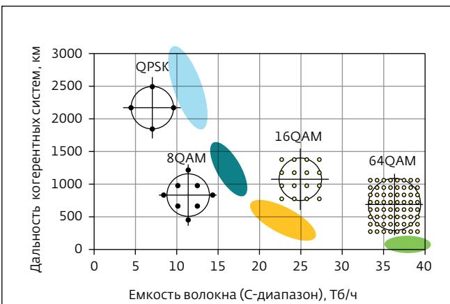
Рис.1. Взаимосвязь пропускной способности и дальности когерентных систем связи, использующих разные форматы модуляции [6]
