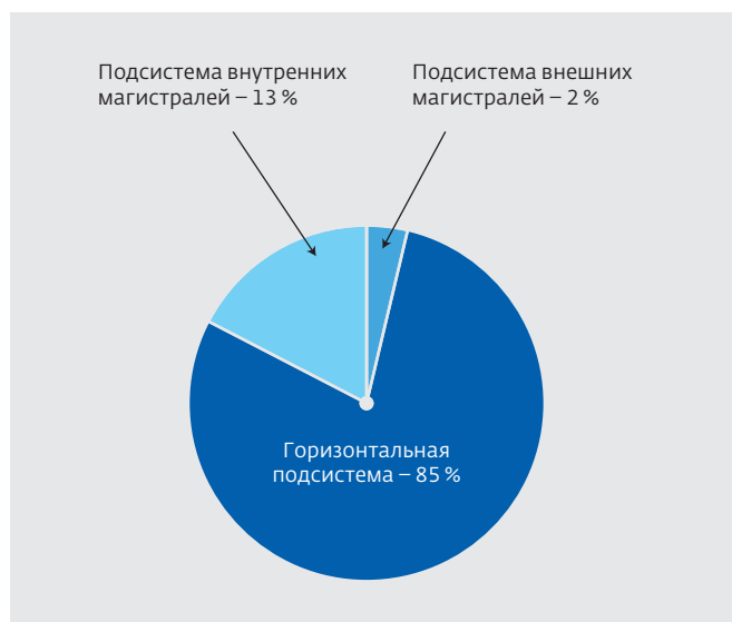
Рис.1. Типовая структура затрат на реализацию полномасштабной СКС (построение по схеме иерархической звезды)
